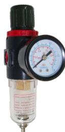
Filtros reguladores de ar com Lubrifer integrado (opcional) e manômetro, tipo miniatura para filtragem e regulagem do ar comprimido que vai para o atuador. Ajuda a prolongar a vida útil tanto da válvula solenóide quanto do atuador pneumático. Para pressão de 0 -10 Bar e conexão de 1/4" BSP.
