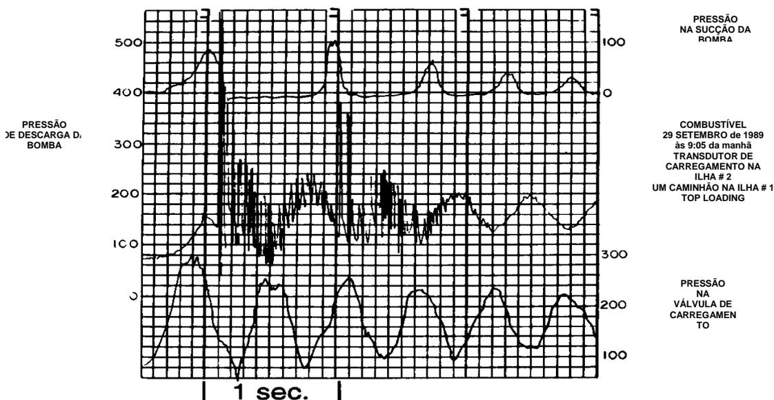
A experiência mostrou ao consultor que esse golpe de aríete ocorria devido ao uso de uma válvula portinhola simples na descarga da bomba. Uma portinhola simples fecha vagarosamente e permite a ocorrência de contra fluxo. Quando a válvula finalmente fecha, o contra fluxo para abruptamente, provocando a formação de pressão muito rápida (golpe de aríete).
